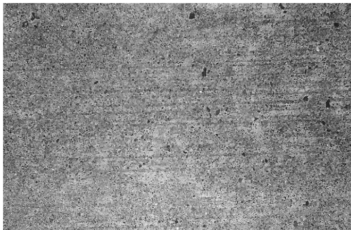
8: Oberflächentextur des Abschnittes mit Steinkohlenflugasche
