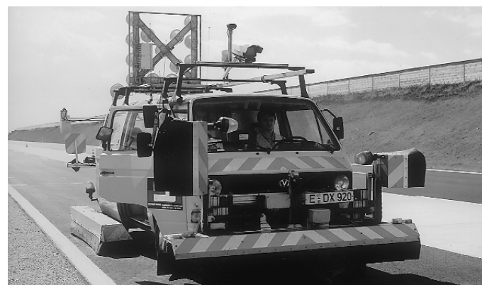
5: ARGUS-Meßfahrzeug – Systemteil Längs- und Querebenheit
