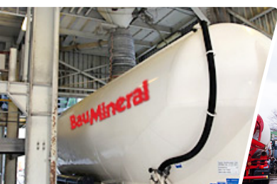
Flugascheabholung im Kraftwerk
